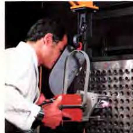
Rohrschweißprobleme sind bei Polysoude in besten Händen. Mit dem Tubomatig-Schweißkopf werden nach dem Wolfram-Inertgas-Verfahren Rohre in Böden geschweißt. Dieses Verfahren garantiert hochwertige, reproduzierbare Schweißnähte.
