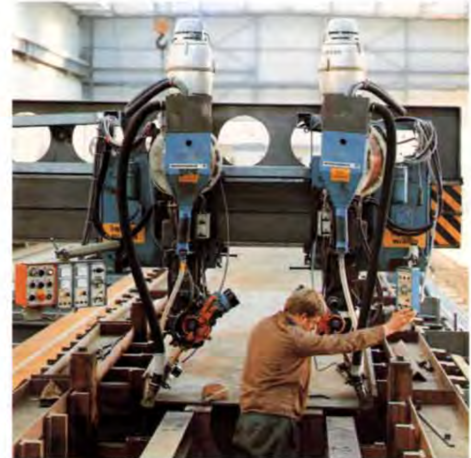
7 m lang ist der Ausleger dieses Automatenträgers bei Nobels Peelman N.V. in Sint-Niklaas, Belgien. Mit zwei Doppeldraht-Schweißköpfen werden nach dem Unterpulververfahren Träger für Brückenkonstruktionen in einem Arbeitsgang geschweißt.
