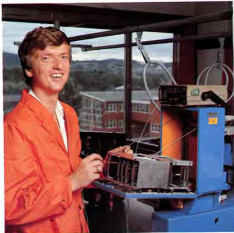
Auch im Ausland arbeiten qualifizierte Mitarbeiter für Kundendienst und Reparatur. Erik Kristiansen prüft hier die Steuerung einer Brennschneidmaschine.
