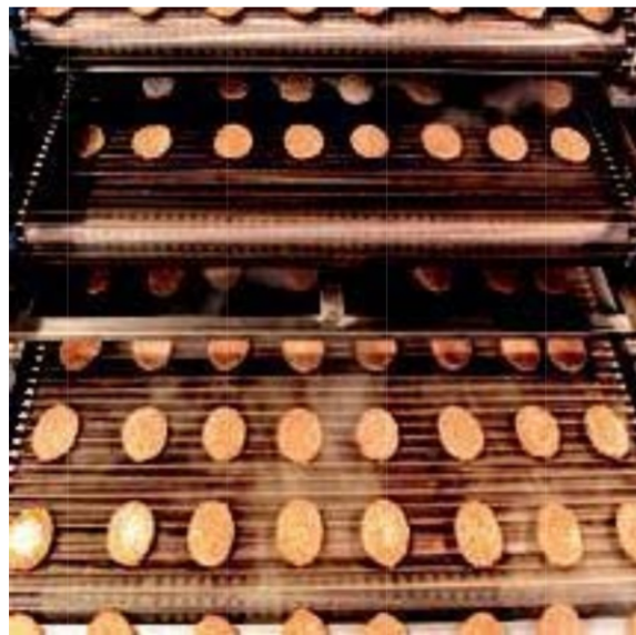
Cryogen-Rapid®-tunel namijenjen je za kontinuirano hlađenje i zamrzavanje prehrambenih proizvoda.
