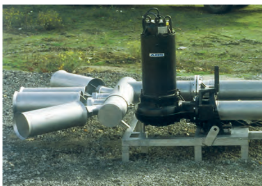
Slika 1: Tehnika injektiranja čistog kisika razvijena od strane Messera: crijevo za dovod plina (lijevo), injektor (sredina), oksidator (desno)
